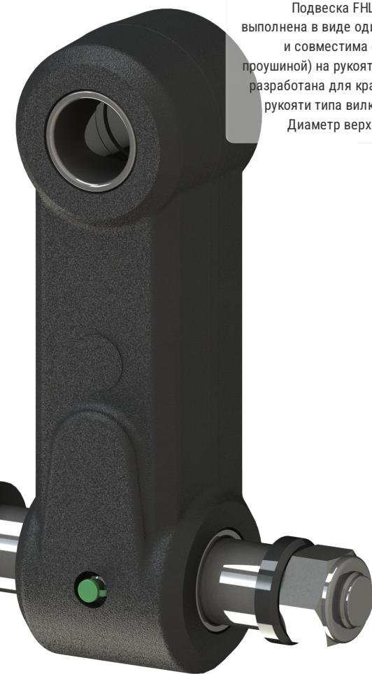
Подвеска или шарнирная подвеска FHL 03 конструкция выдерживает нагрузки до 16т. Подвеска FHL 03 изготовлена из устойчивой к ударам и деформации кованой стали. Подвеска – это необходимый элемент для соединения рукояти крана с ротатором и грейфером или другим навесным оборудованием. В любой отрасли – лесозаготовка, сельское хозяйство, погрузка материалов – подвески Formiko, безусловно, лучшее решение.
